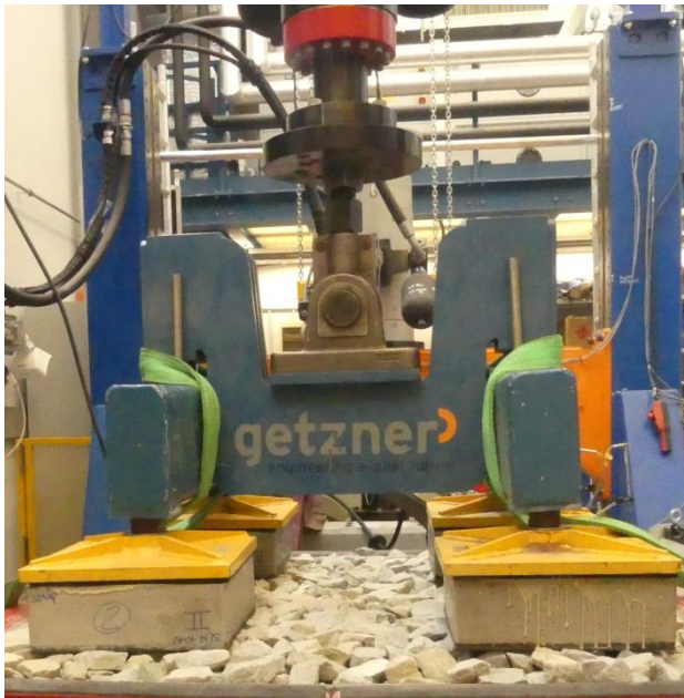
Abbildung 21: Konsolidierungsvorgang im Labor (eig. Abb.)
