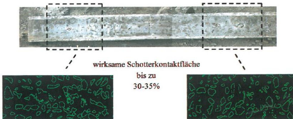
Abbildung 4: Digitale Kontaktflächenanalyse bei besohlenen Betonschwellen nach dem Ausbau 8
