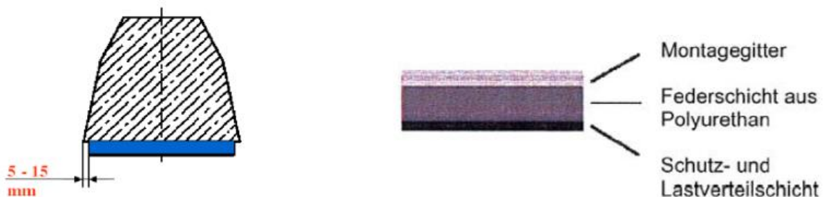
Abbildung 2: Querschnitt einer besohnten Schwelle und möglicher Aufbau einer Schwellenbesohlung
