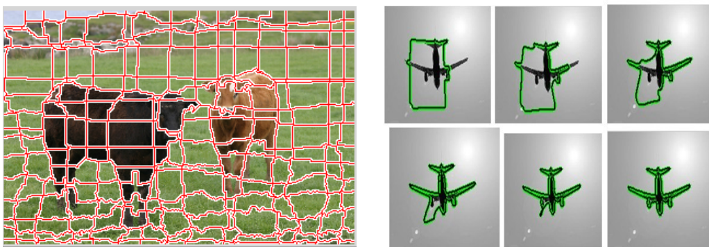
Abbildung 4. Bild Segmentierung (li.) und Aktive Konturen (re.)
