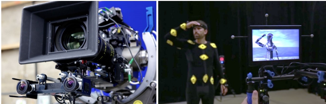
Abbildung 13. markerlose NCam (li.) und markerbasiertes System Optitrack Insight (re.)
