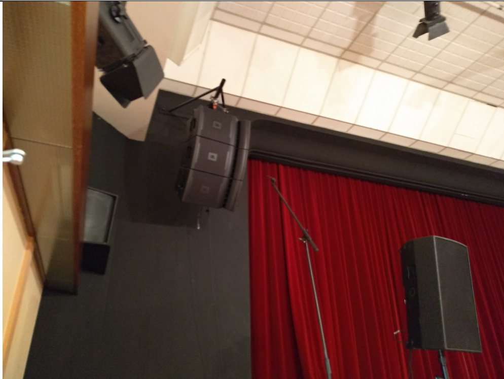
Abbildung 39. Positionierung des Messmikrofons für die Messung der Voltage Sensitivity eines JBL VRX 932LA-1 Elements.
