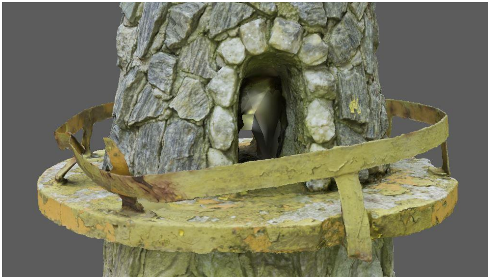
Abbildung 69. Detailansicht des Balkons des von RealityCapture erstellten Modells, mit nicht komplett rekonstruiertem Durchgang
