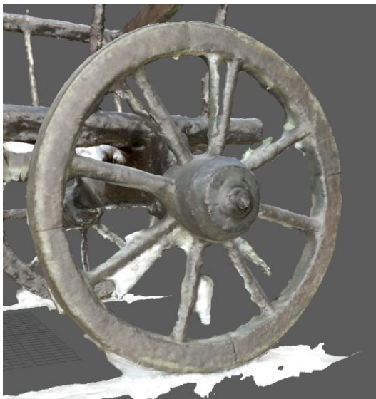
Abbildung 88. Hinterrad mit weißen Polygonartefakten
