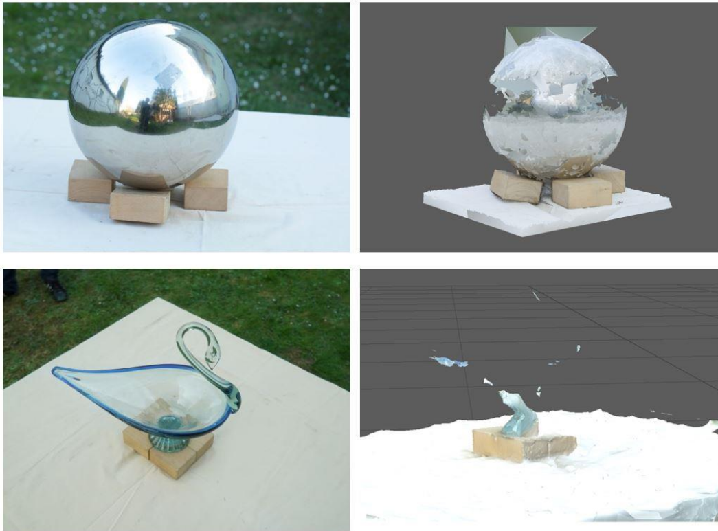
Abbildung 2. Oben die tatsächliche Chromkugel mit der 3D Rekonstruktion und unten der Glasschwan, der beweist, dass Glas auch nicht geeignet ist.
