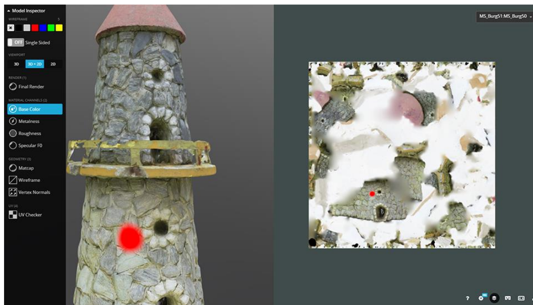
Abbildung 129. Der 3D Viewer von Sketchfab in gesplitteter Ansicht; links das Modell, rechts die Textur, der rote Punkt hilft hierbei den korrekten Abschnitt auch auf der Textur daneben zu finden.
