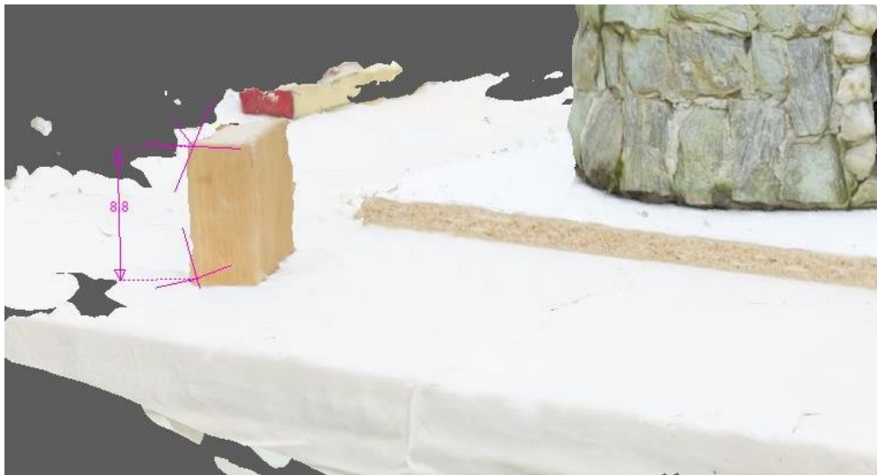
Abbildung 53. Höhe des Quaders nach der Skalierung
