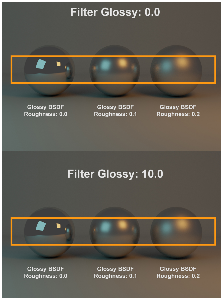
Abbildung 3. Vergleich von Spheres mit Glossy BSDF und verschiedenen Roughness Werten mit dem Filter Glossy Wert 0.0 und 10.0 (vom Autor mit Blender 2.79 erstellt und mit Cycles gerendert)
