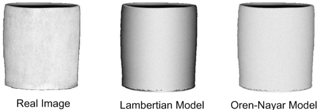
Abbildung 5. Vergleich des Lambertschen Modelles mit dem Oren Nayar Modell ( https://www.semanticscholar.org/paper/Generalization-of-the-Lambertian-model-and-for-Oren-Nayar/45d4f4f956f5a618a233836edfd1686ed4ee68da/figure/24 )
