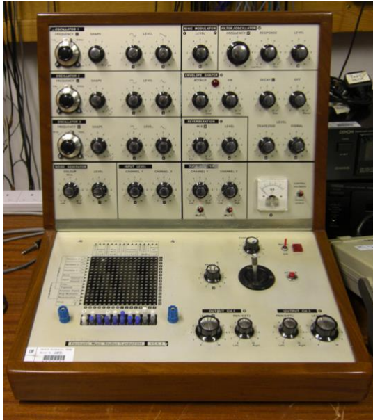
Abbildung 7 VCS-3 Synthesizer der Firma EMS. Einer der ersten Synthesizer mit Diode Ladder Filter.
