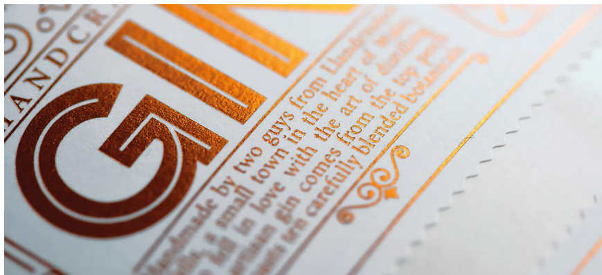
Abbildung 28: Heißfolienprägung Quelle: (CCL Label Trittenheim, o. J.-I)
