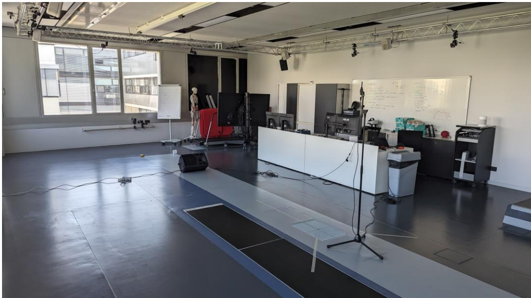
Abbildung 19: Setup für die raumakustische Messung mit der Software REW.
